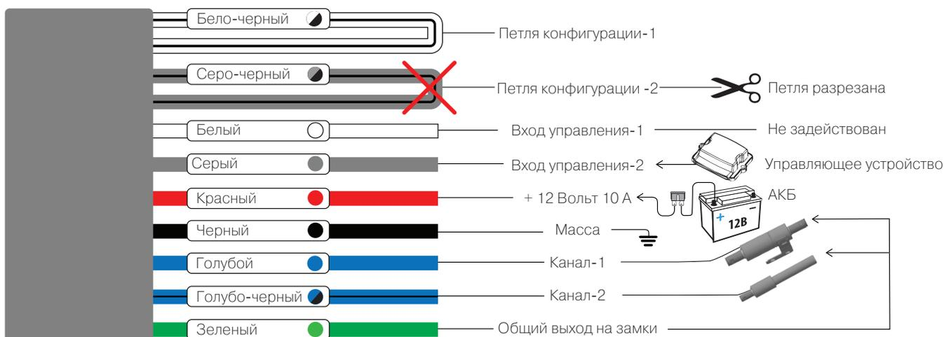
В данном режиме контроллер ожидает по линии «Вход управления — 2» серии из 2-х (открытие) или из 3-х (закрытие) импульсов. Главное условие - общая длительность последовательности - не более 2-секунд. Минимальная длительность активного уровня — 0.2 секунды. Сквозность — 1:6
