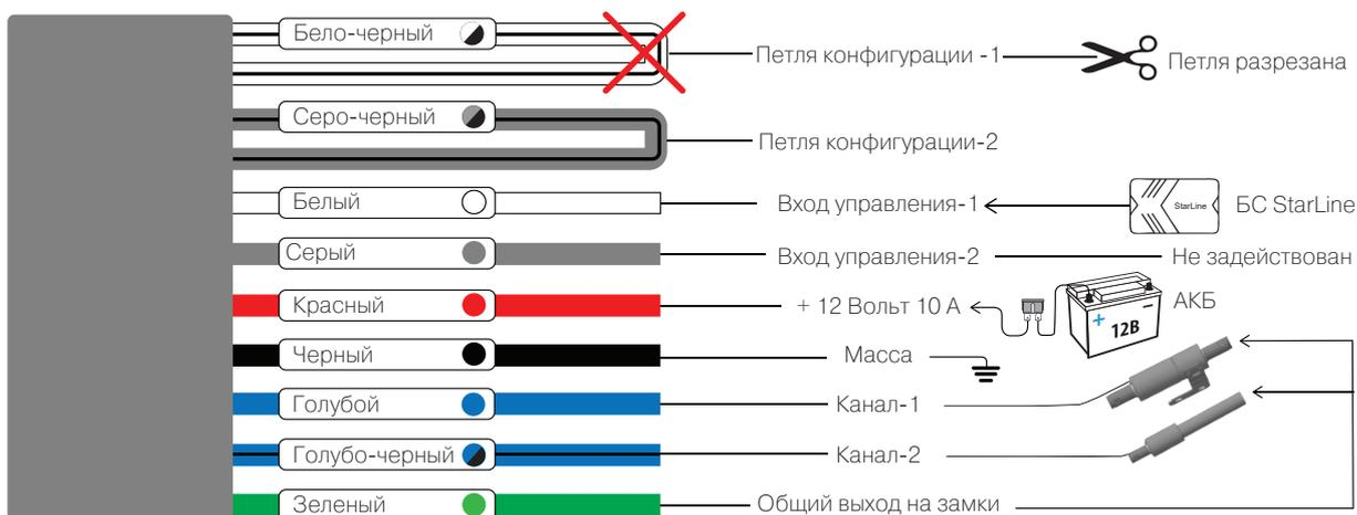
В данном режиме контроллер управления MR3L эмулирует работу кодового реле R4 Starline в объеме, необходимом для управления электромеханическими блокираторами «Капот и КПП». Для связи используется линия «Вход управления — 1» (Работа Контроллера управления MR3L обеспечивается с блоками охранных комплексов StarLine третьего и четвертого поколения с версиями ПО от K7 до L9 и от M8 и выше. ©)
